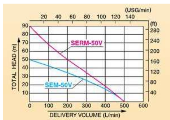
Slika 6 - Karakteristike visokopritisne pumpe Koshin SEM50v
